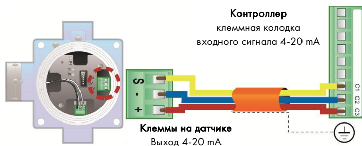
Рис 9: подключение искробезопасного 2-проводного детектора 4-20 мА с диодом Зенера
