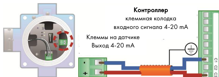
Рис 8: подключение 2-проводного детектора 4-20 мА
