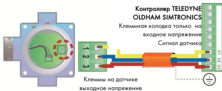
Рис 11: подключение 3-проводного детектора типа OLC 100
